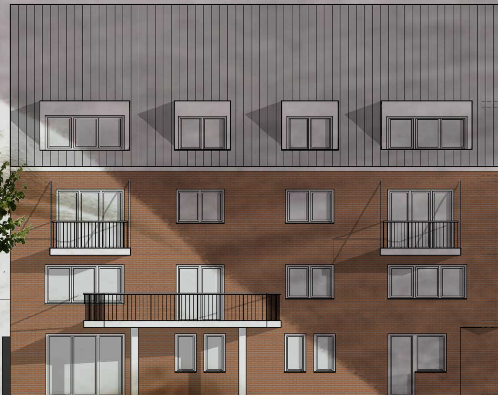
Ansicht Hofseite: Wohnungen im 2. Obergeschoss mit neuer Balkonanlage.
